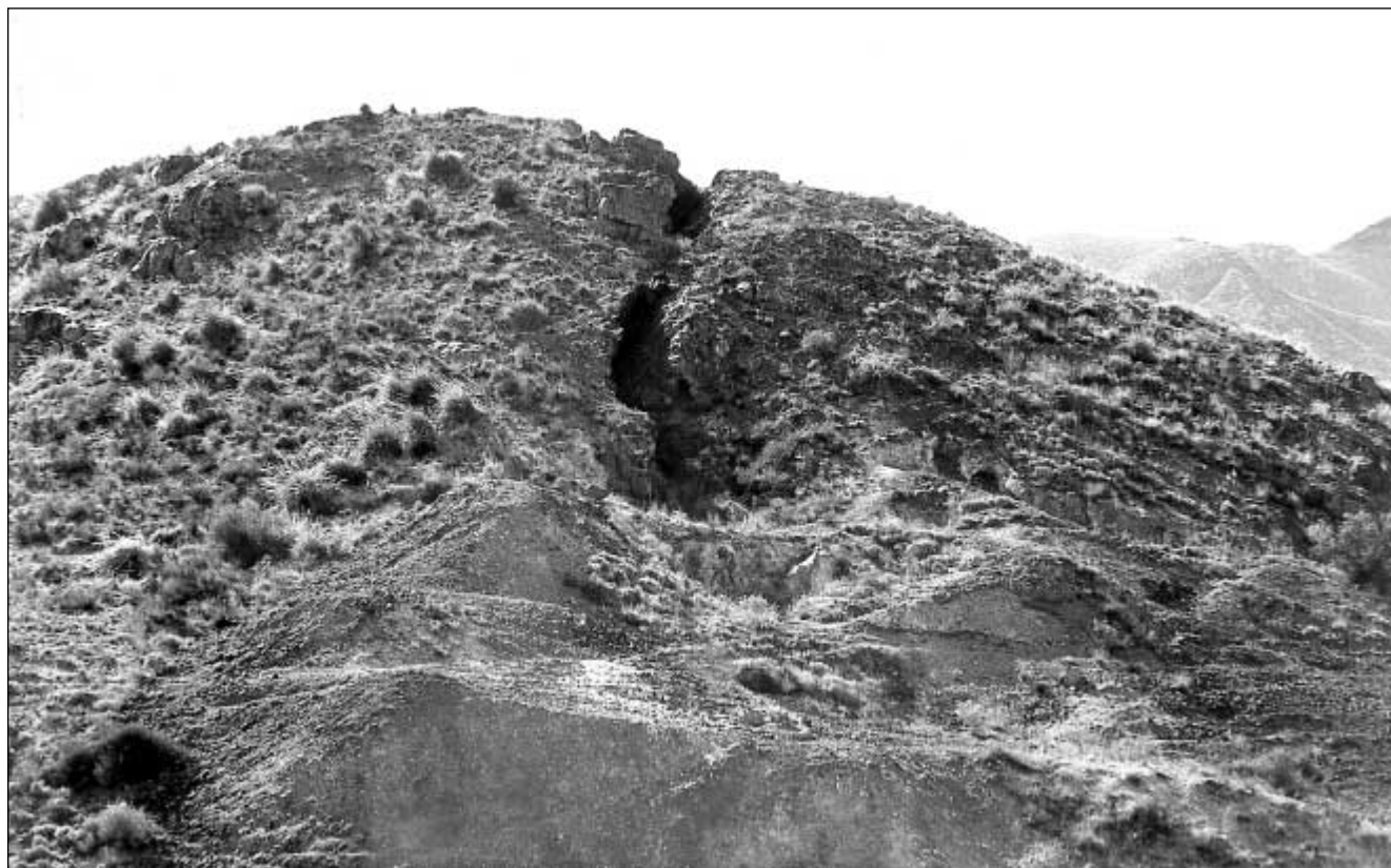
Foto 2.- Explotación minera en trinchera. Cabezo El Roble.
